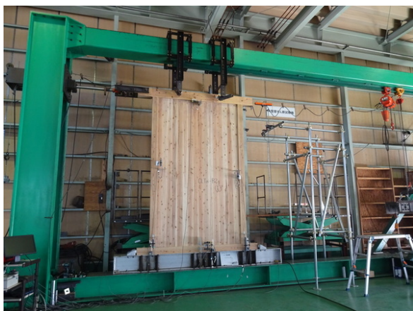
実大壁試験による耐震強度確認
